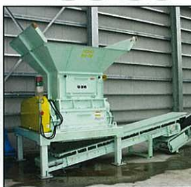
中間処理業者リサイクルプラント /混合廃棄物破碎
